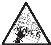
No utilizar el perno porta-rueda como asidero para levantar la máquina.
