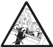
Für das Anheben der Maschine niemals die Radträgerwelle als Hebelpunkt verwenden.
