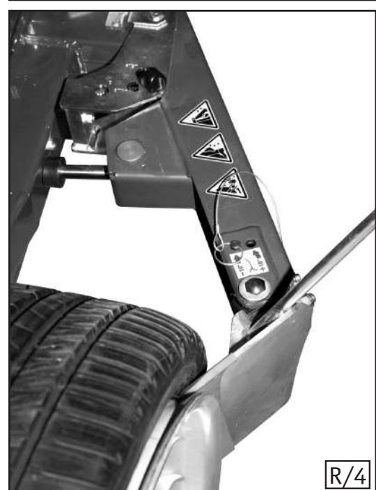
La procédure de détalonnage sur des roues avec pneus RUN FLAT, SURBAISSÉS, UHP demande l'utilisation du limiteur de course (voir Fig. R/3), livré sur demande.
