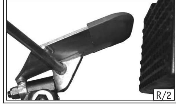
**Le bras détalonneur du démonte-pneus S 45 a 2 positions de travail (voir Fig. R/1 et R/2) :**
