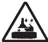
Die Hände und andere Körperteile so weit wie möglich vom Spanntisch entfernt halten, wenn dieser sich dreht, weil Quetschgefahr besteht.
