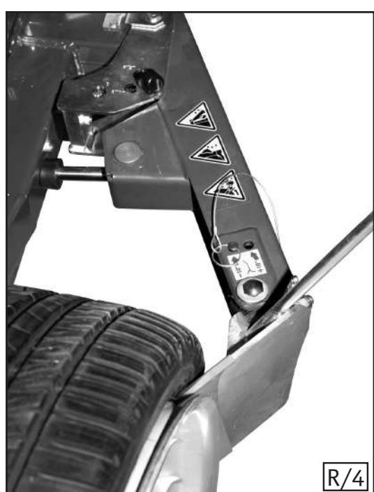
**El procedimiento de destalonadura en ruedas RUN FLAT, REBAJADAS y UHP requiere el uso del limitador de carrera (véase Fig. R/3), disponible bajo pedido.**
