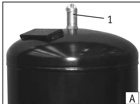
Die Version **S 45 GP** verfügt ferner über ein **Überdruckventil (1, Abb. A)**, das sich am externen Druckluftspeicher befindet und auf 11 bar eingestellt ist. Dieses Ventil nimmt seine Funktion jedes Mal auf, wenn der Druck innerhalb des Druckluftspeichers auf über **11 bar** ansteigt.
