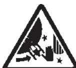
Beim Abdrücken besteht für die Hände Quetschgefahr zwischen Felge und Spanntisch.
