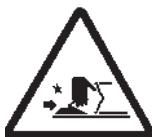
Beim Radaufspannen besteht für die Hand Quetschgefahr zwischen Felge und Spannklaue.
