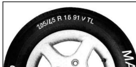
**ATTENTION :** il est catégoriquement interdit de monter des pneus sur des jantes n'ayant pas le même diamètre. De plus, il est interdit de monter des pneus d'une taille autre que celle mentionnée sur la carte grise par le fabricant du véhicule.
