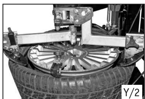
**9-** Lancer la rotation de l'autocentreur tout en accompagnant manuellement la rotation du bras mobile, en veillant à ce que le protège-talon en plastique reste en correspondance du point de traction (**cf. Fig. Y/2**).
