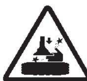
No poner las manos sobre la rueda: el retorno de la columna en posición de "trabajo" puede provocar su aplastamiento entre la llanta y la torre.
