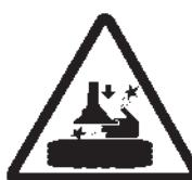
Ne pas appuyer les mains sur la roue: le retour du montant dans la position de "travail" pourrait provoquer l'écrasement entre la tourelle et la jante.
