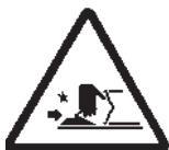
Danger d'écrasement des mains entre la jante et la griffe en phase de blocage du pneumatique.
