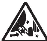
Peligro de aplastamiento de las manos entre lanta y autocentrante durante el destalonado.
