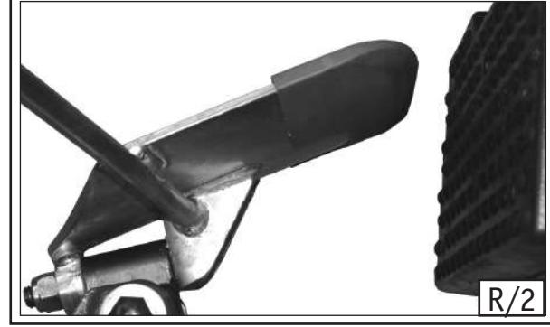
**Der Abdrückerarm der Reifenmontiermaschine S 45 weist zwei Arbeitspositionen auf (siehe Abb. R/1 und R/2):**
