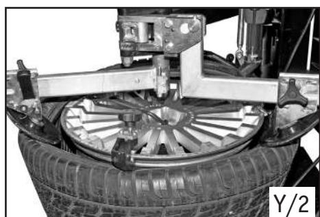
**9-** Iniziare la rotazione dell'autocentrante e simultaneamente accompagnare manualmente la rotazione del braccio mobile avendo cura che la protezione in plastica per la salvaguardia del tallone rimanga posizionata in corrispondenza del punto di trazione (**vedi Fig. Y/2**).
