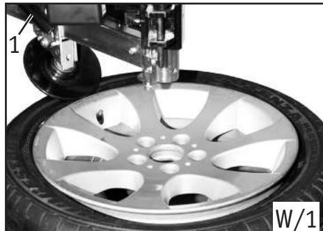
2- Con la maniglia (1, Fig. W/1) in posizione verticale, regolare la posizione del disco premittalone in base al diametro della ruota, bloccarlo quindi a circa 10 mm dal bordo esterno del cerchio e portarlo nuovamente sul suo finecorsa (vedi Fig. W/1).
