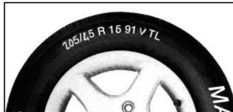
**ATTENZIONE:** È assolutamente vietato montare pneumatici su cerchi che abbiano un differente valore di calettamento, ed è inoltre vietato montare pneumatici di dimensioni diverse da quelli indicati dal costruttore del veicolo nella carta di circolazione.
