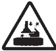
En remettant le bras dans la position de travail ne pas appuyer les mains sur la jante pour éviter les risques d'écrasement entre la tourelle et la jante.
