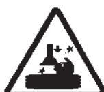
Peligro de aplastamiento de las manos entre la llanta y torreta durante las operaciones de montaje y demontaje.
