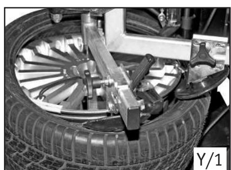
**4-** Régler la position du disque presse-talon en fonction du diamètre de la jante.
