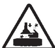
Al colocar el brazo porta-útil en la posición de trabajo no apoyar las manos en la llanta para evitar el riesgo de que aplaste las manos entre la torreta y la propia llanta.
