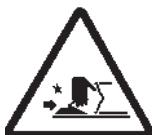
Peligro de aplastamiento de los manos entre llanta y garras en fase de bloqueo del neumático.
